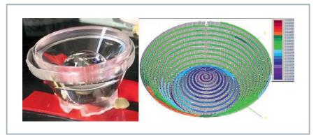
Figure 2. Scanning sensitive surfaces (© Werth Messtechnik)
